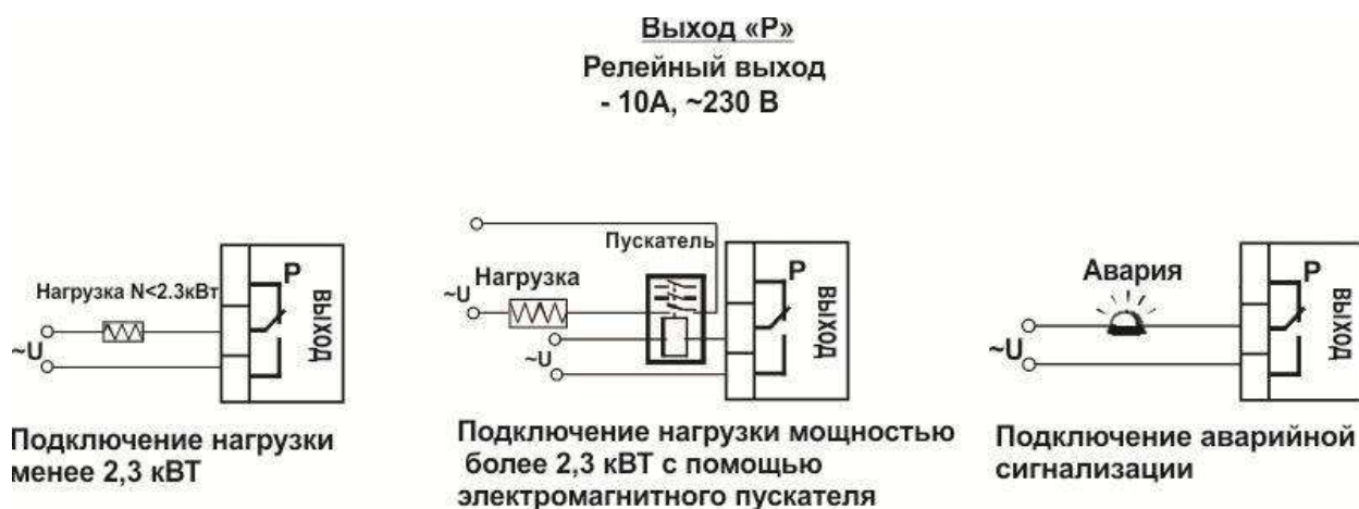
Рисунок 5 – Схемы подключения релейных выходов.
